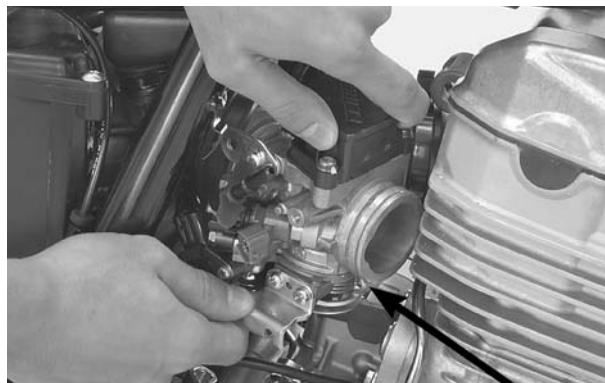
CORPO DO ACELERADOR ENCAIXE DE CONEXÃO RÁPIDA PARAFUSO
