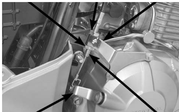
BRAÇO DE ACIONAMENTO CABO DA EMBREAGEM SUPORTE DOS CABOS AJUSTADOR CONTRAPORCA
