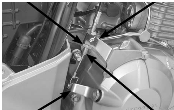
BRAÇO DE ACIONAMENTO CABO DA EMBREAGEM PARAFUSO DE FIXAÇÃO DO RESSONADOR
