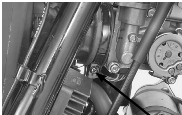
PARAFUSO DA BRAÇADEIRA DA MANGUEIRA DE CONEXÃO PARAFUSOS DE FIXAÇÃO/ESPAÇADORES
