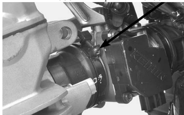
PARAFUSO DA BRAÇADEIRA DA MANGUEIRA DE CONEXÃO PARAFUSO DA BRAÇADEIRA DO ISOLANTE
